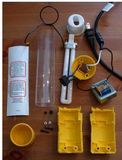
ถอดส่วนประกอบหลอดไฟออก เพื่อจะได้แยกเอาสวิตช์กับหลอดไฟ ไว้สำหรับติดนอกกล่องคอมพิวเตอร์
